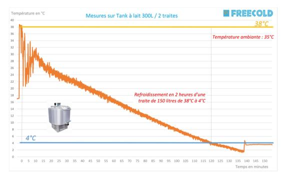
NOTA : Dans le cas de 2 traites quotidiennes (matin et soir), la traite du matin sera introduite dans la cuve du tank à lait, 1 heure minimum après le lever du soleil pour que la centrale solaire ait commencé à recharger les batteries
